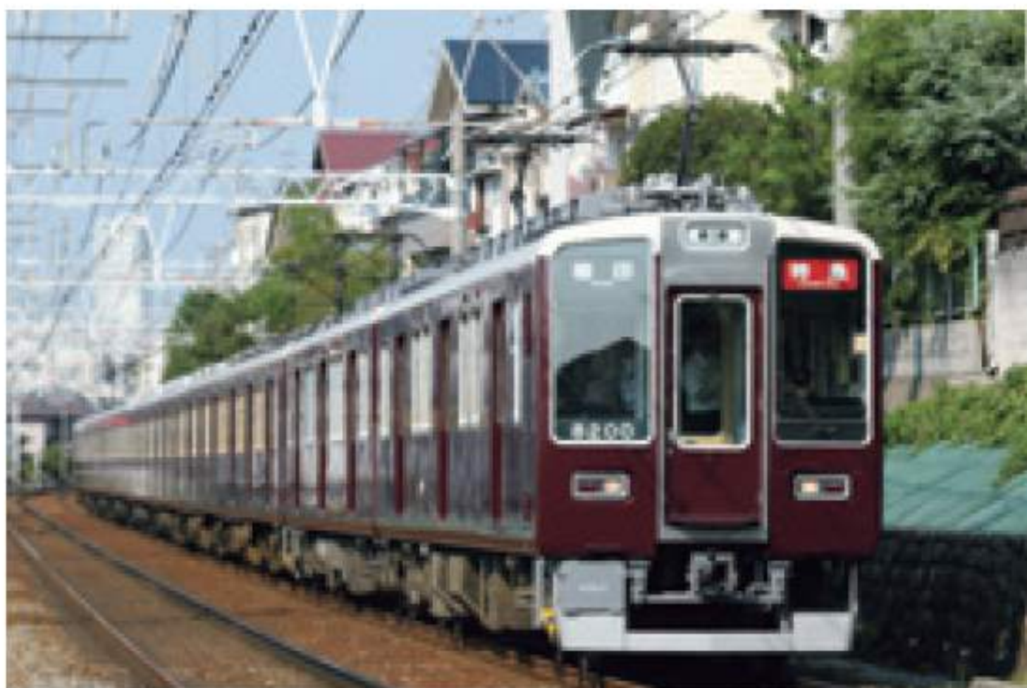
8200系は1995年に登場、側面の窓割りが変更され、窓の数が少ない。神戸線の配置で、平日朝だけ運用されている。 岡本～芦屋川 2019年8月1日 写真/林 浩一
