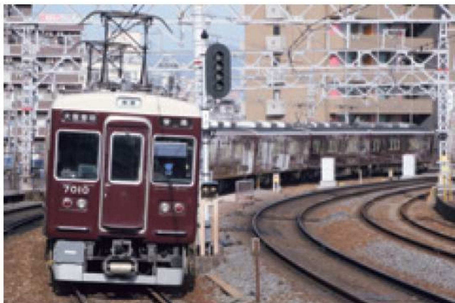
7010×8と7020×8はリニューアルに際して前面の車号を移設したが、制御方式は界磁チョップパ制御を維持した。 十三～中津 2021年3月20日 写真/井亀宏志
