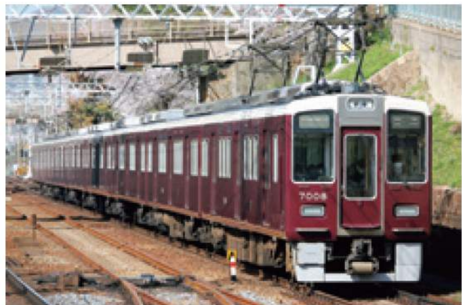
2009年と翌年にリニューアルされた7007×8と7008×8。界磁チョップパ制御のまま、前面に大きく手が加えられた。 六甲～御影 2021年4月1日 写真/宗則克彦
