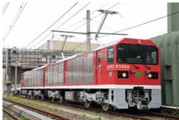
大江戸線に入る関係で車体は小振りとなっているE5000。その分集電装置が高々と上がる。馬込車両検修場 2017年11月8日 写真/編集部
