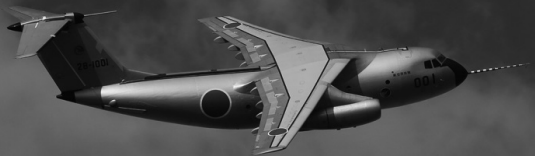
航空自衛隊C-1輸送機の試作初号機を改造した、C-1FTB (写真:小久保陽一)
