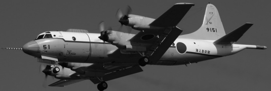
P-3Cを改造した評価試験機。新開発の機器の空中試験を行う (写真:藤原稯)
